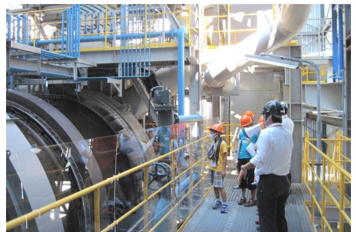
巨大なロータリーキルン(焼却溶融炉)を見学。近づくとも熱気でとても暑かったです。
