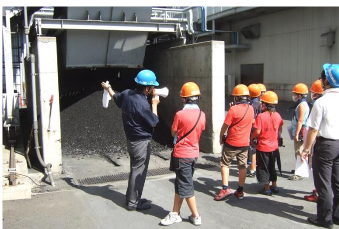
こちらは排出直後の溶融スラグ。まだ熱をもっていて、ここから加工設備に送られ人工砂になります。
