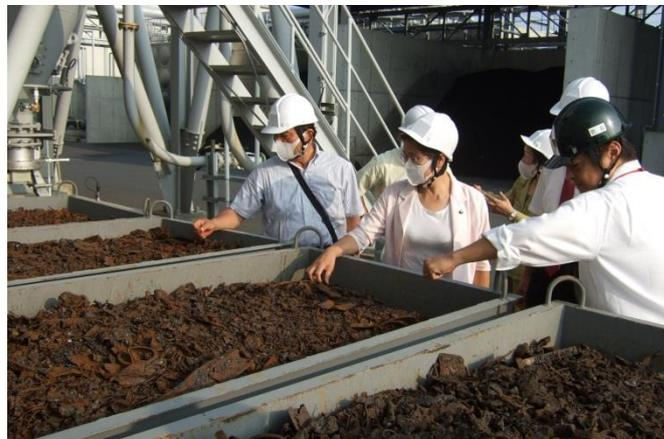
溶融スラグ加工工程で選別された金属類
